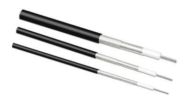
射频电缆的衰减与导体,介质,结构尺寸,工艺水准和工作的频率都有着很大的关系。1、外导体编织一般60%-80%为宜,偏大对降低衰减效果不是很明显。2、绝缘生产用的模具设计和加工也是关键,应该保证产品达到较理想的均匀结构,使等效介点常数达到设计要求。3、物理发泡PE其衰减在低频是合格,而高频时超差,大都与介质损耗角正切值和等效介点常数偏大有关系,或者与外导体编织密度过小,内导体外直径偏小有关系。提醒:射频电缆的衰减常数还取决于发泡程度。在阻抗和回波的允许范围内适当增加发泡度有助于增加电缆的衰减常数,还可以降低成本。
