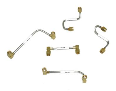
半刚性射频电缆顾名思义,这种电缆不容易被轻易弯曲成型,其外导体是采用铝管或者铜管制成,其射频泄漏非常小(小于-120dB□□在系统中造成的信号串扰可以忽略不计。这种电缆的无源互调特性也是非常理想的。如果要弯曲到某种形状,需要专门用的成型机或者手工的模具来完成。如此麻烦的加工工艺换来的是非常稳定的性能,半刚性电缆采用固态的聚四氟乙烯材料作为填充介质,这种材料具有非常稳定的温度特性,尤其在高温条件下,具有非常良好的相位稳定性。半刚性电缆的成本高于半柔性电缆,大量应用于各种射频和微波系统中。轧纹系列射频电缆制造商射频电缆组件的正确选择除了频率范围,驻波比,插入损耗等因素外,还应考虑电缆的机械特性。
